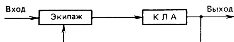
Схема ручного режима управления. Космонавты сами, без участия бортовой автоматики, выполняют операции по управлению космическим аппаратом
