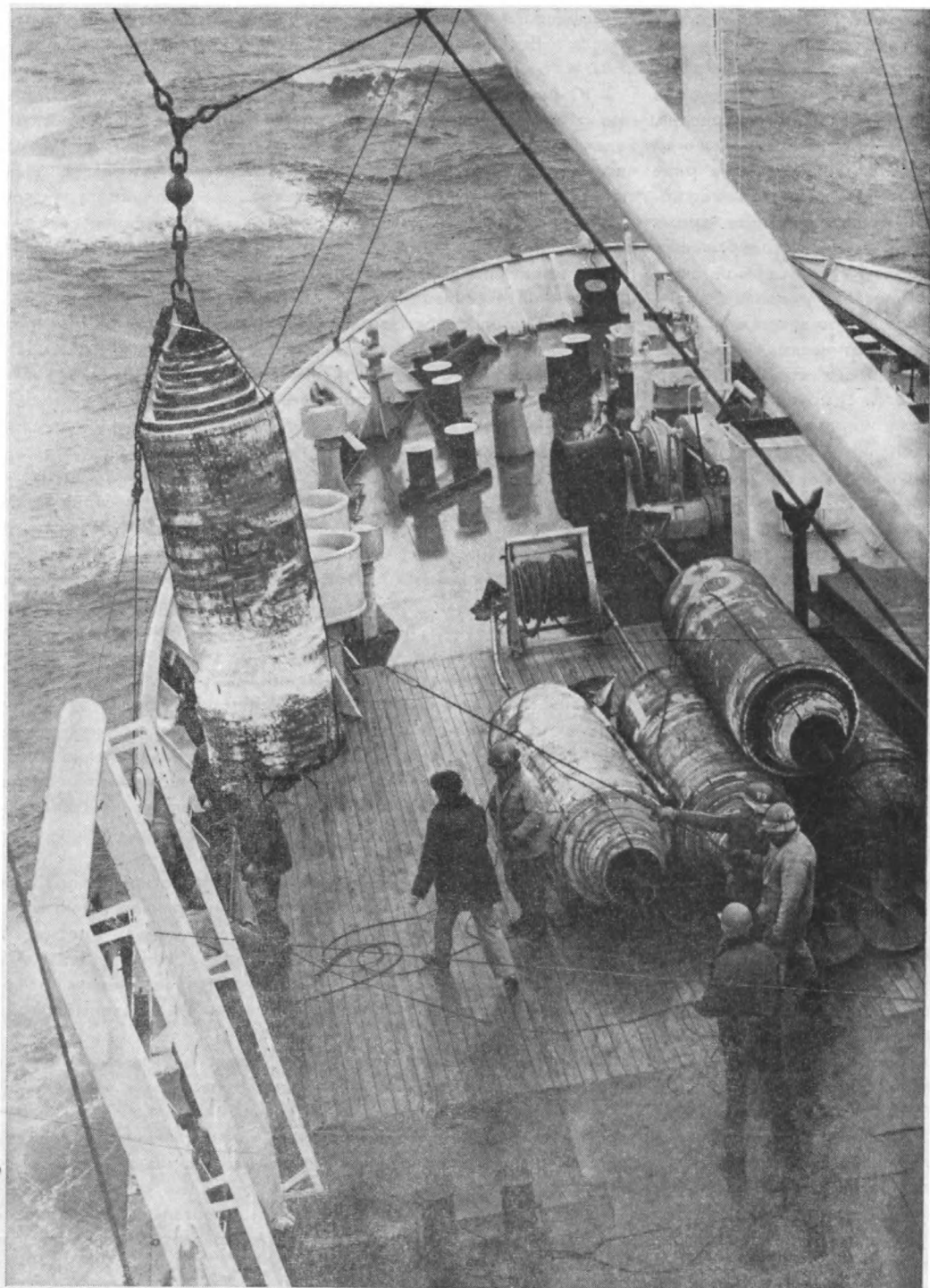
Замена буя автономной якорной буйковой станции, поврежденного во время шторма
