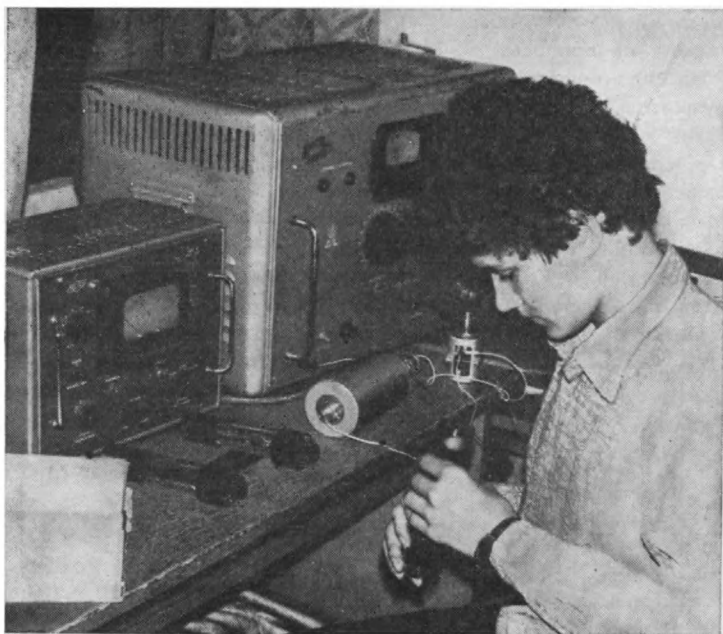
Виталий Киселев занят изготовлением электрофотометра для наблюдения переменных звезд
